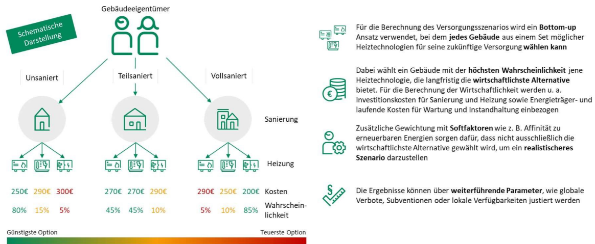
Abbildung 22 Schematische Darstellung des Entscheidungsprozesses der zukünftigen Heiztechnologie
